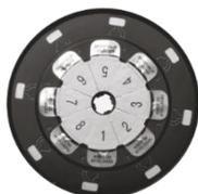
*Permette l'analisi in contemporanea o in momenti diversi di 8 campioni biologici ed è stato studiato per consentire l'analisi di materiale genetico senza la necessità di doverlo estrarre, elemento questo differenziante rispetto ad alcuni prodotti della concorrenza che invece richiedono procedure di purificazione prima di poter eseguire l'analisi.*
